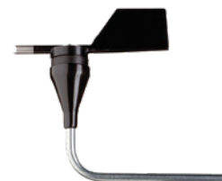
La girouette mesure la direction du vent.
