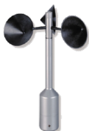
L'anémomètre mesure la vitesse du vent.
